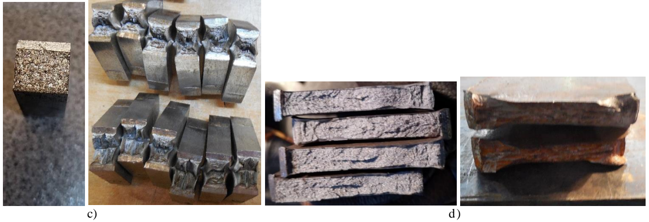
Fig. 4: Aspecte macro reprezentative ale secțiunii de rupere după testarea la: tracțiune & proba Z - a), îndoire - b), impact - c) și DWTT - d)
