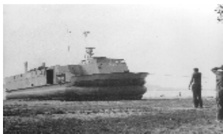
Nava pe pernă de aer amfibie – Desant Marin Proiect Ac 1043 probe de sustentație și stabilitate
