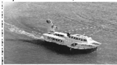
Model captiv 018E, motoare aeromodel pentru propulsie și sustentăție - experimente pe lacul Brateș.
