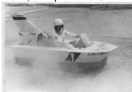
Foto : Modelul -09E –motor “Mobra 68 cm3”
