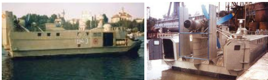
Foto: Nava amfibie pe pernă de aer pentru DESANT MARIN – Pr. 1043
